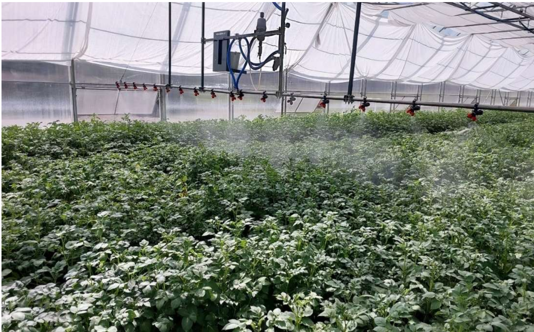
ПОЛИВ КАПЕЛЬНЫМ СПОСОБОМ С ПОМОЩЬЮ АВТОМАТИЗИРОВАННОЙ ПОЛИВОЧНОЙ РАМПЫ «ХОЗАГРО»
